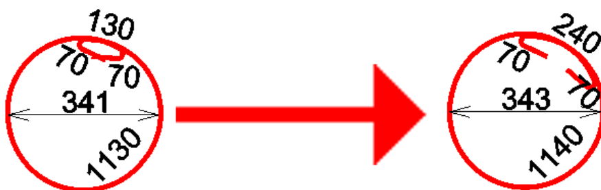
Obr. Kruhový třmínek před a po změně přesahu.
