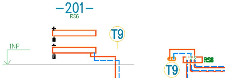
Obr. Ukázka automatického vykreslení rozdělovače z půdorysu do schématu pro podlahové vytápění.
